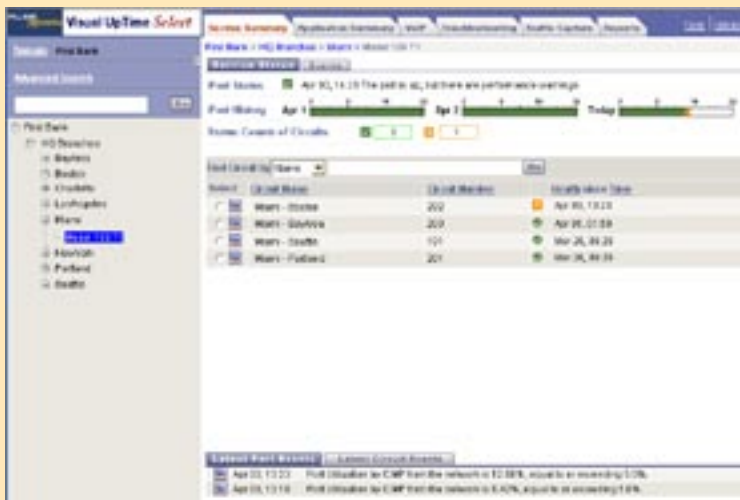
Figure 1 : Utilisez les seuils personnalisables pour définir des déclencheurs sur le réseau.
